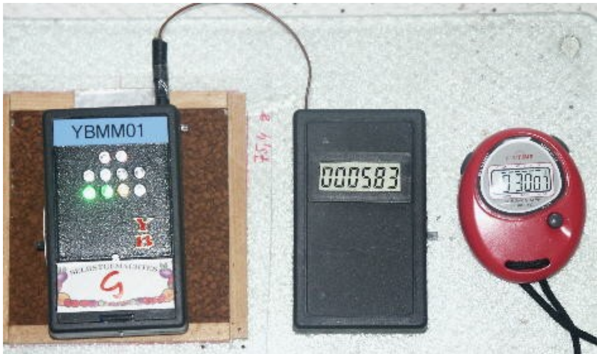
Bild3: Messen der Aktivität von geringen Mengen pulverförmiger Stoffproben
