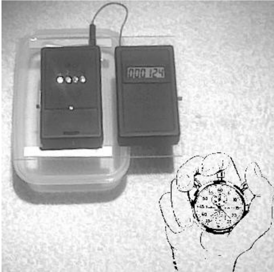
Bild2: Aktivitätsmessung an Stoffproben mit dem YB-Mini-Monitor + digitaler Impulszähler
